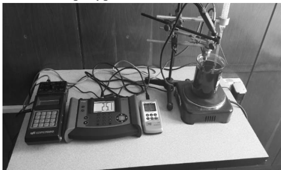
Фиг. 3.1 Експериментална установка за определяне влиянието на динамичните характеристики на датчиците за температура
