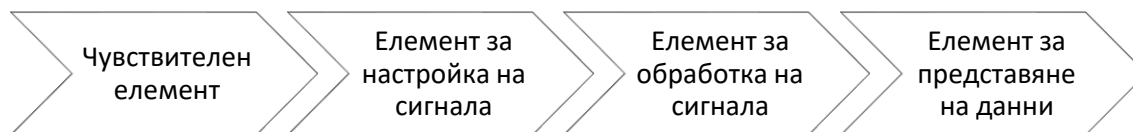
Фиг. 2.1 Условна блокова диаграма на измерителна система
